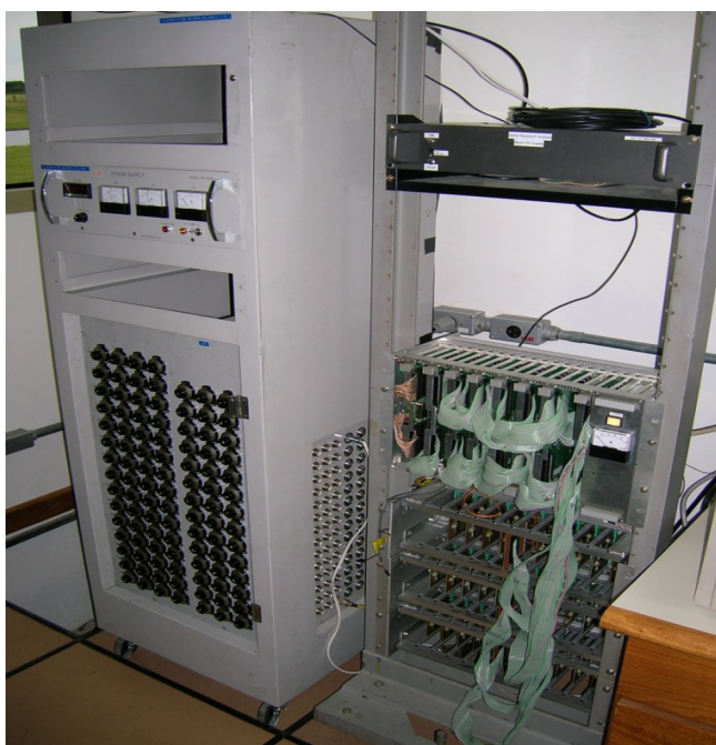
Figura 20 – Racks que suportam os potenciômetros, sistemas de processamento de dados e fontes de baixa e alta tensão.
